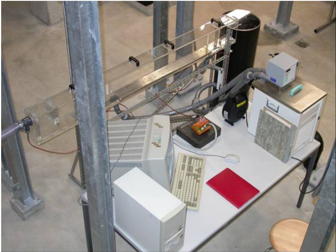
Abb. 4.1: Prüfstand für die Untersuchung des Einflusses der Biofilmbildung auf die Leistung des Wärmetauschers
