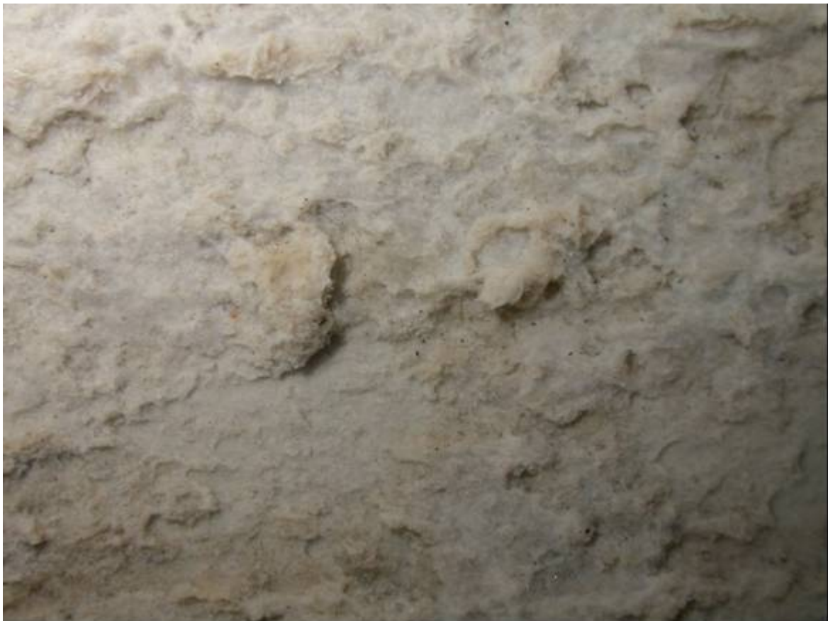
Abb. 4.4: Nahaufnahme eines Biofilms, der in 16 Tagen auf dem Wärmetauscher aufgewachsen war. Das Bild zeigt einen Ausschnitt der Biofilmoberfläche von 1,8 x 2,4 cm
