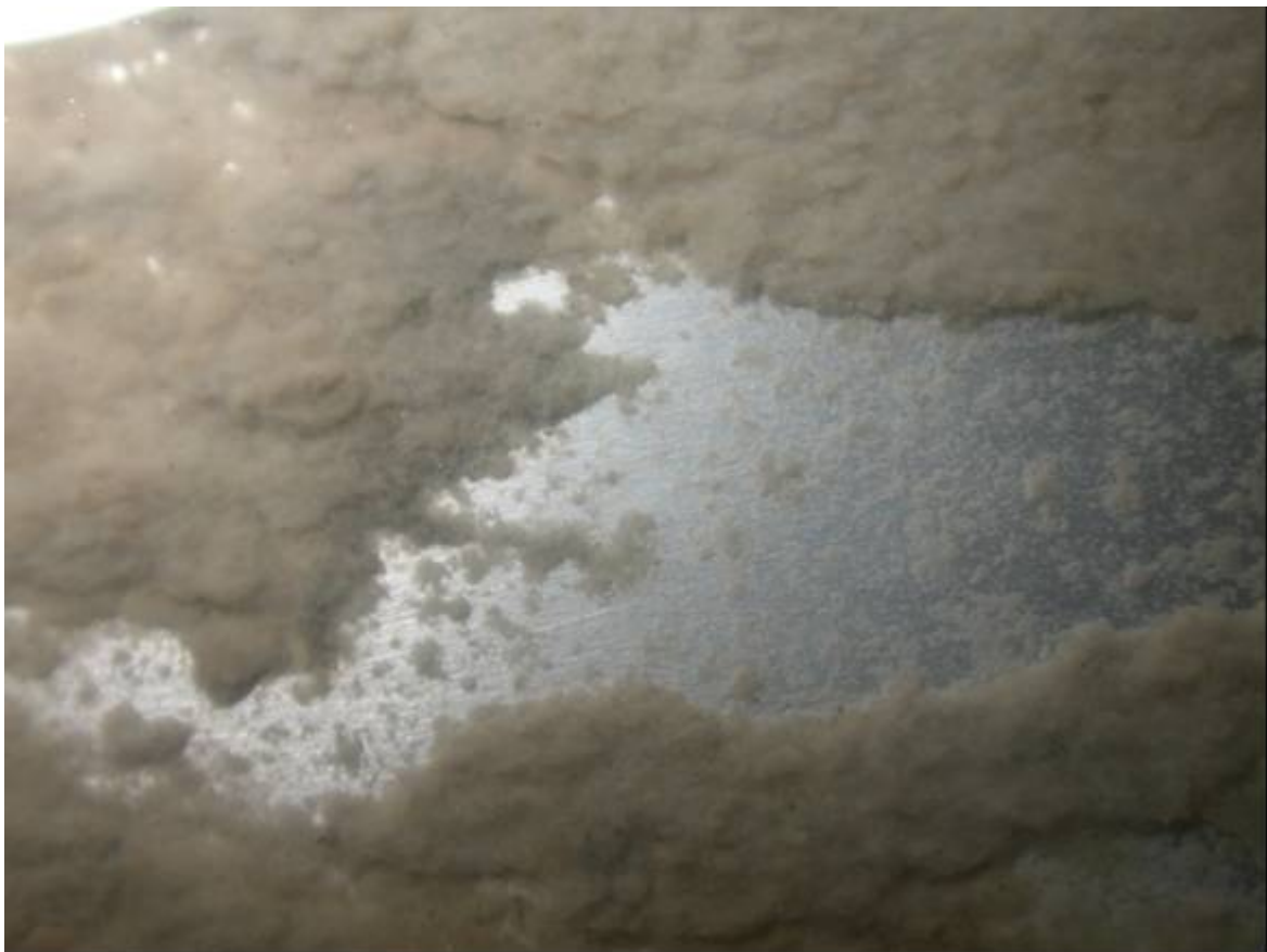
Abb. 4.6: Nahaufnahme der Biofilmoberfläche nachdem Teile des Biofilms durch erhöhte hydraulische Belastung abgeschwemmt worden waren. Das Bild zeigt einen Ausschnitt der Biofilmoberfläche von 2,4 x 3,2 cm
