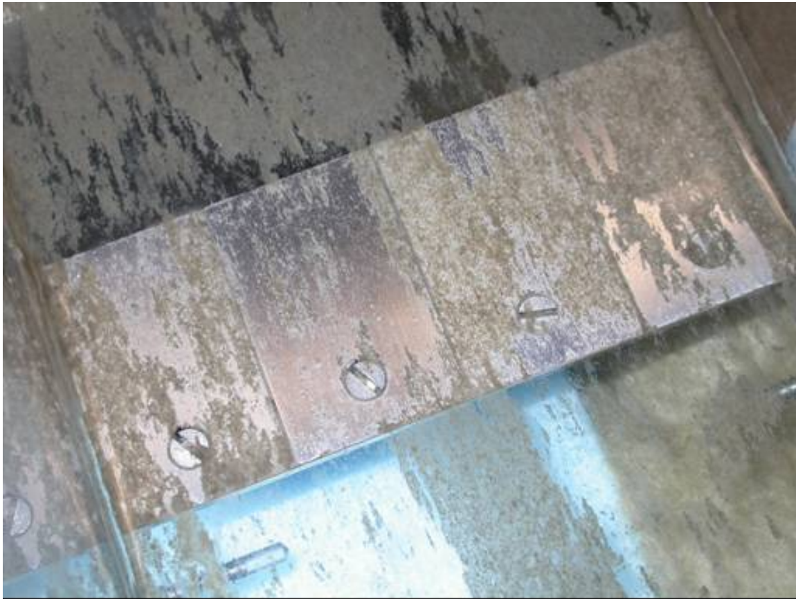
Abb. 4.9: Testplättchen zur Untersuchung der Biofilmbildung in der Abwasserrinne
