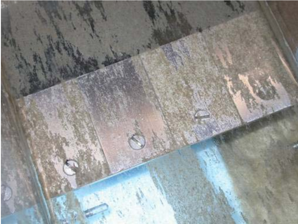
Abbildung 1: Testplättchen zur Untersuchung der Biofilmbildung in der Abwasserrinne
