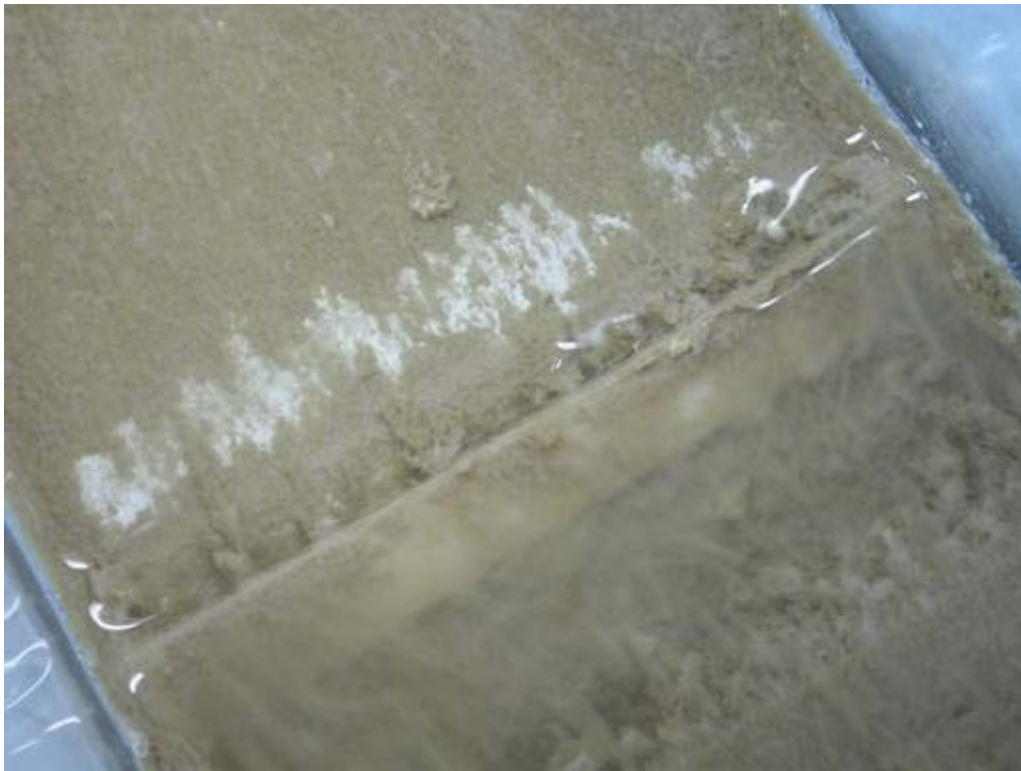
Abbildung 6: Störung des Strömungsfeldes in der Abwasserrinne durch eingebauten Plexiglassteg
