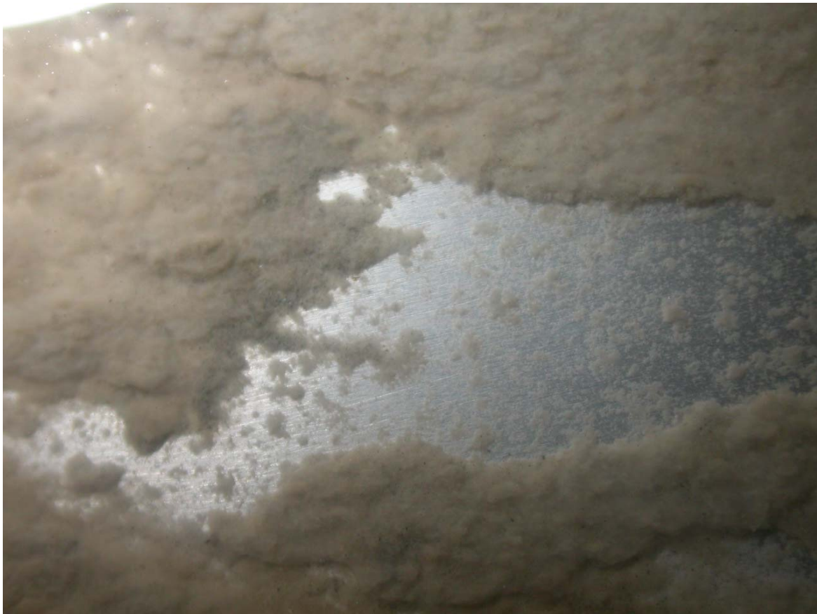
Abbildung 6: Nahaufnahme der Biofilmoberfläche nachdem Teile des Biofilms durch erhöhte hydraulische Belastung abgeschwemmt worden waren. Das Bild zeigt einen Ausschnitt der Biofilmoberfläche von 2,4 x 3,2 cm.
