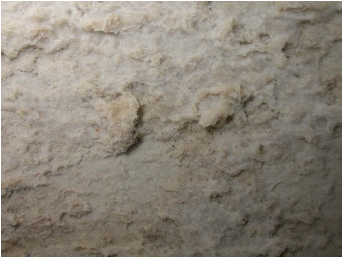
Abbildung 4: Nahaufnahme eines Biofilms, der in 16 Tagen auf dem Wärmeübertrager aufgewachsen war. Das Bild zeigt einen Ausschnitt der Biofilmoberfläche von 1,8 x 2,4 cm.
