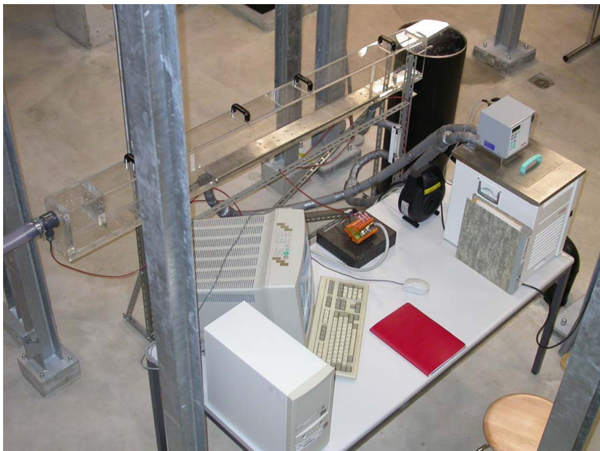
Abbildung 1: Prüfstand für die Untersuchung des Einflusses der Biofilmbildung auf die Leistung des Wärmeübertragers.
