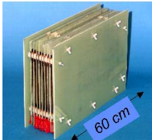
Abbildung 5: Seriell geschaltete Strombegrenzersmodule
