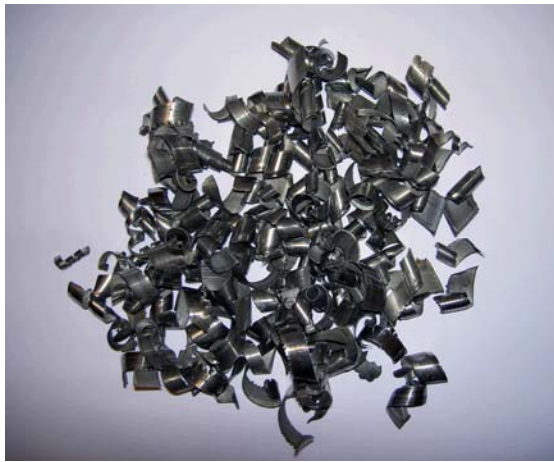
ABB. 3.2.3.1 Die Chromstahlspäne werden je nach Anwendung speziell oberflächlich behandelt.
