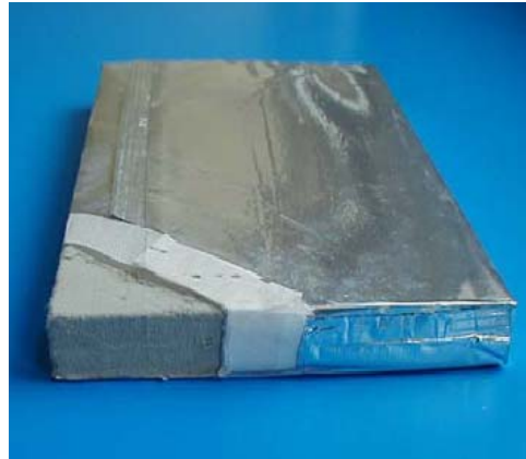
Vakuum-Isolations-Paneele (VIP) sind 8 bis 10 mal leistungsfähiger als konventionelle Dämmstoffe.
