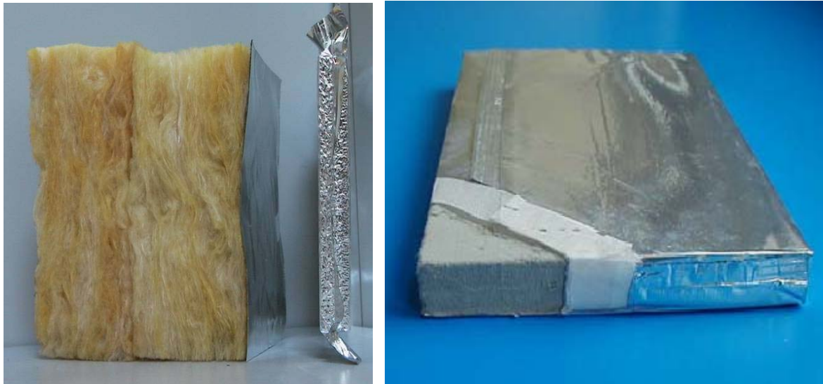
Fig. 1: Vakuum-Isolations-Paneele (VIP), 8 bis 10 mal leistungsfähiger als konventionelle Dämmstoffe.
