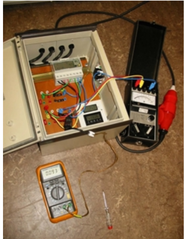
Fig. 2 Messausrüstung für Standby-Messungen (EMU 32 dreiphasig, umsteckbare Ein-/Ausgänge, Drehspul-Wattmeter, Stromzange/ Vielfachmessgerät)
