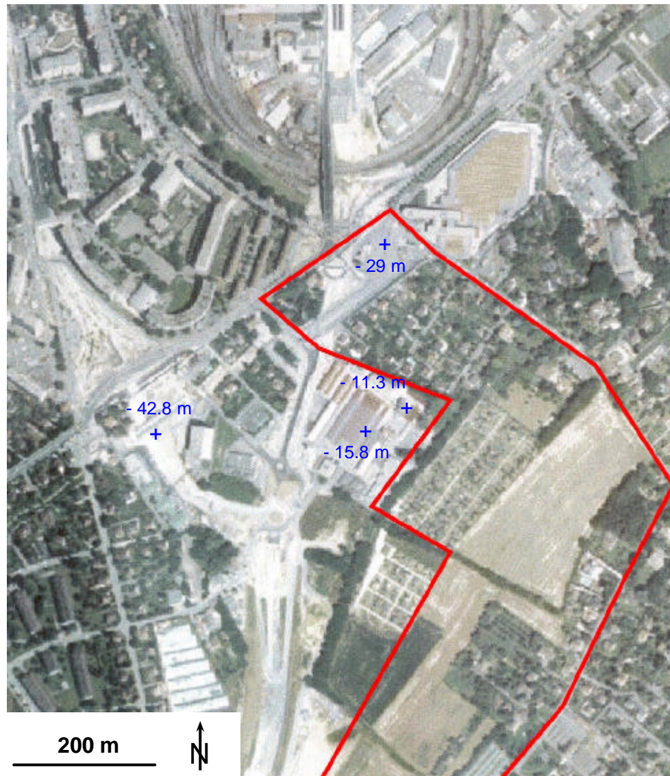
Figure 4.2 : Partie nord de la zone de développement futur du périmètre d'aménagement coordonné de La Chapelle - Les Sciers, délimitée en rouge sur cette vue aérienne. Les sondages ayant atteint les graviers de l'alluvion ancienne sont représentés par des croix bleues avec indication de la profondeur de l'interface.
