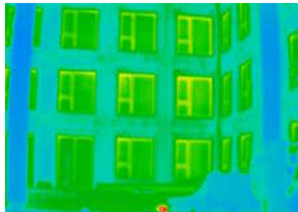
Auch bei den zum Hof hin orientierten Fassaden sind keine Einflussfaktoren von Wärmebrücken oder luftundichten Stellen feststellbar.
