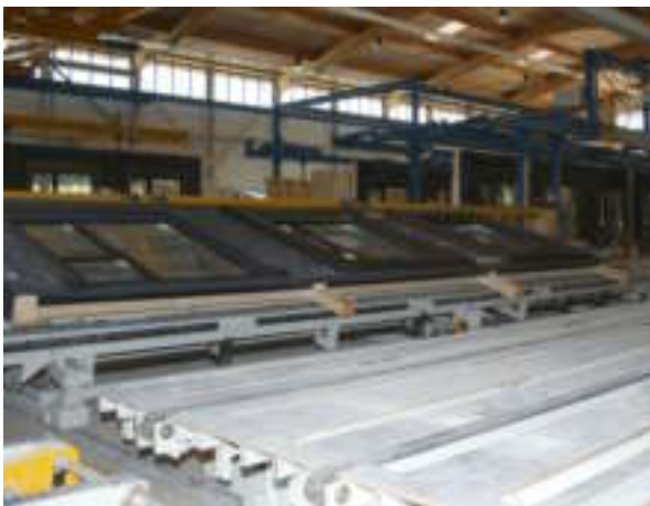
Parallel zu den Baumeisterarbeiten beginnt die Produktion der Holzelemente im Werk der Renggli AG in Schötz.
