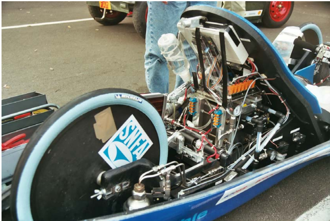
Figure 13 :le compartiment moteur de PAC-Car.
