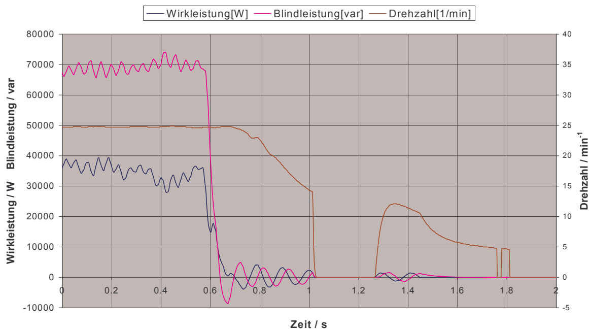
Abb. 12: Wirkleistung, Blindleistung und Drehzahl über der Zeit beim Auslauf
