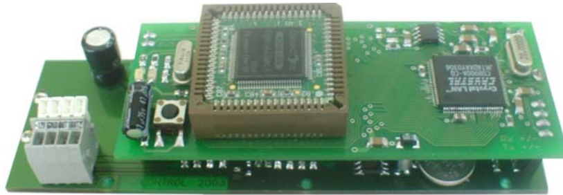
Bild 3: Ansicht der von eigens entwickelten Elektronik mit Web-Server von ConnectOne, Microcontroller und getakteter Spannungsversorgung
