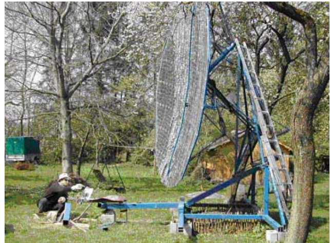
Im Fokus eines 8\text{m}^2 Reflektors wird das Zinn geschmolzen und dann heiss zugeschweisst.
