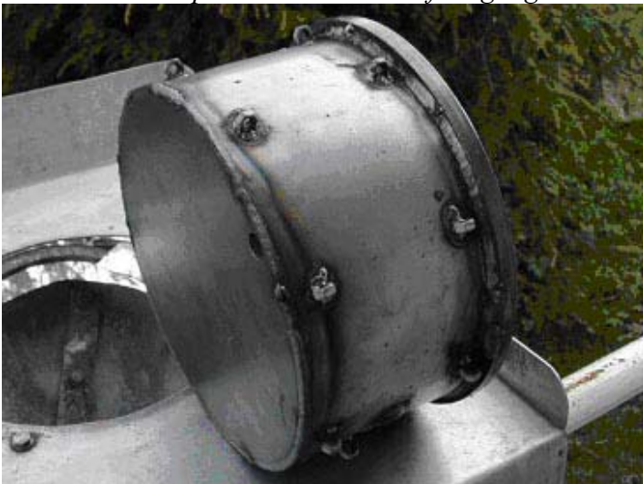
Der zugeschweisste Zinnspeicher.
