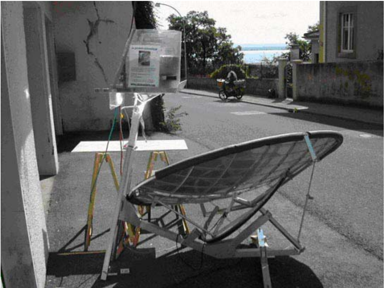
Der 2m 2 Parabolspiegelkocher mit dem Hitzespeicher. Der Reflektor bündelt das Sonnenlicht auf die Unterseite des Speichers, der etwas erhöht auf dem Ständer steht. Der Reflektor richtet sich automatisch nach der Sonne.
