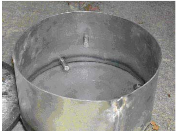
Der Unterteil des Zinnspeichers. Die Stifte beherbergen die Thermometer.
