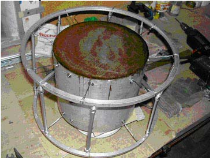
Der Aluminiumspeicher in seiner Aufhängung.
