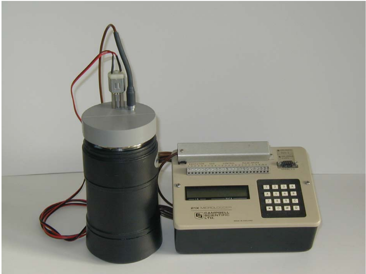
Figure 2 : Photo du montage ; Sur la gauche le Dewar, datalogger CR21X sur la droite.
