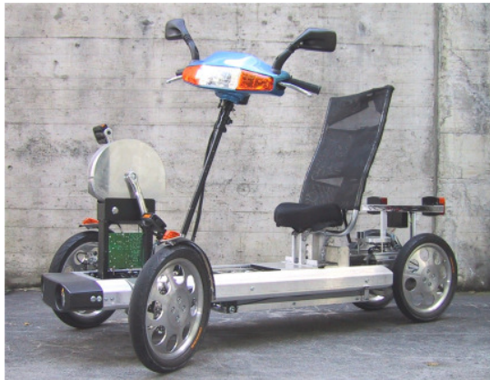
Abb. 1 Vierrad von Jakob Gilgen. Das „Gilgen Vierrad“ stellt den Stand der Arbeiten zum Zeitpunkt der Projektdefinition 2002 dar. Links der Prototyp mit dezentraler Steuerung. Rechts das Design der Karosserie, die ebenfalls als Prototyp existiert (Design ECAL, Bergeron & Clement 1999)
