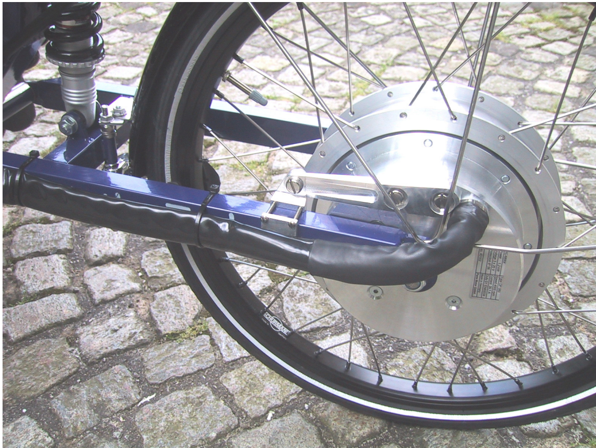
Abb. 19 Radnabenmotor DiscPower in der Schwinge des Digitrike. Der Hebel verhindert Drehung des Motor in der Schwinge. Unter dem nach vorne kommenden, zylindrischen Gehäuse verbirgt sich die elektrische Maschine (PMS 080).
