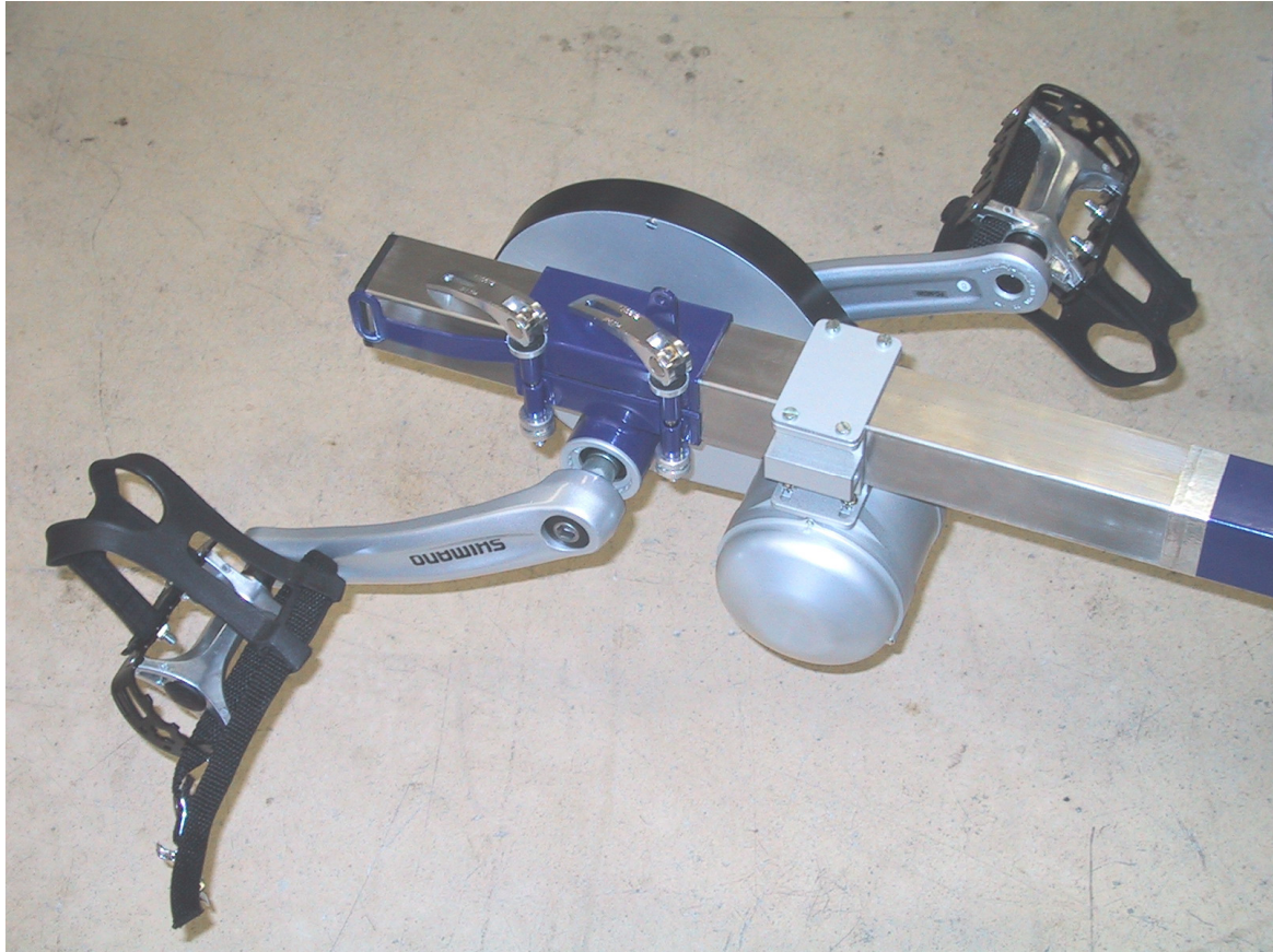
Abb. 18 Ansicht des Tretgenerator von links (Das Display des Digitrike ist hier nicht montiert). Im zylindrischen Gehäuse befinden sich die 2. Getriebestufe (Planetengetriebe) sowie der Generator (Nur die Pedale sind von Shimano, nicht der Tretgenerator!)
