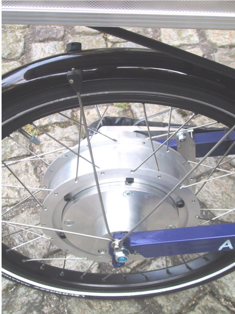
Abb. 20 Rechte Seite (zweistufiges Planetengetriebe) des DiscPower Radnabenmotor
