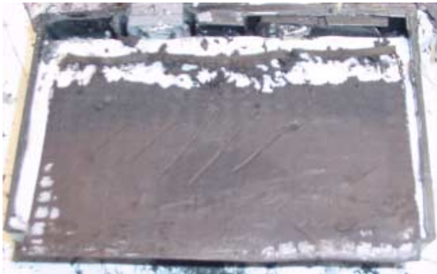
Bild 17: Die defekte Plusplatte: Im oberen Bereich ist die Gitterkorrosion deutlich zu erkennen.
