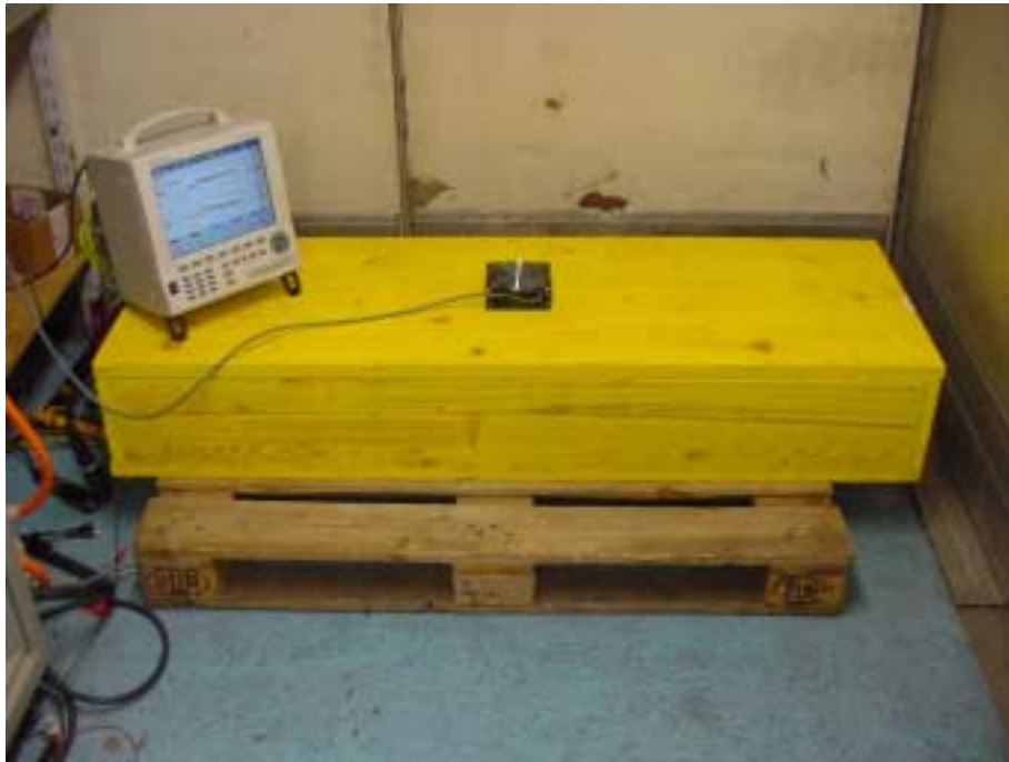
Bild 7: Einbau der Batterie 280303 in eine Holzkiste. Seitliche Bohrungen und ein Ventilator auf der Kiste sorgen für die Kühlung der Batterien.
