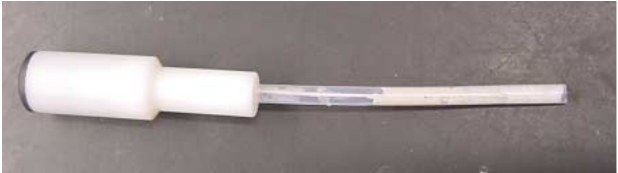
Bild 4: Die Ruetschi-Sonde ist eine Silber-Silbersulfat Referenzelektrode. Der schlauchförmige Teil der Elektrode (im bild rechts) kann durch das Entlüftungsventil in die Batterie gesteckt werden. In Bezug auf diese Referenzelektrode haben die positiven Platten eine Spannung von etwa +1 Volt, die negativen Platten eine Spannung von etwa -1 Volt.
