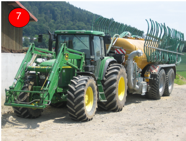
Abbildung 8: Das vergorene Material mit einem Trockensubstanzgehalt von 2-8% wird maschinell mit dem Schleppschlauchverfahren ausgetragen.
