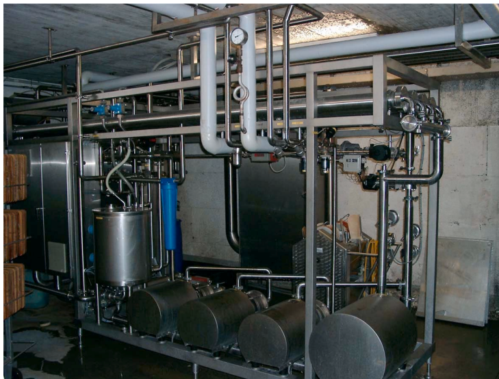
Bild 1 : Umkehrosmoseanlage der LESA mit Druckpumpen (im Bild unten)
