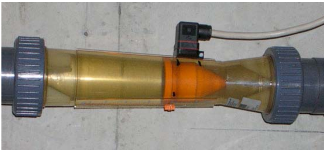
Abbildung 8 : Kobold-Durchflusswächter mit Schwimmer-Position in Betriebslage (Aufnahme um 90 Grad gedreht).
