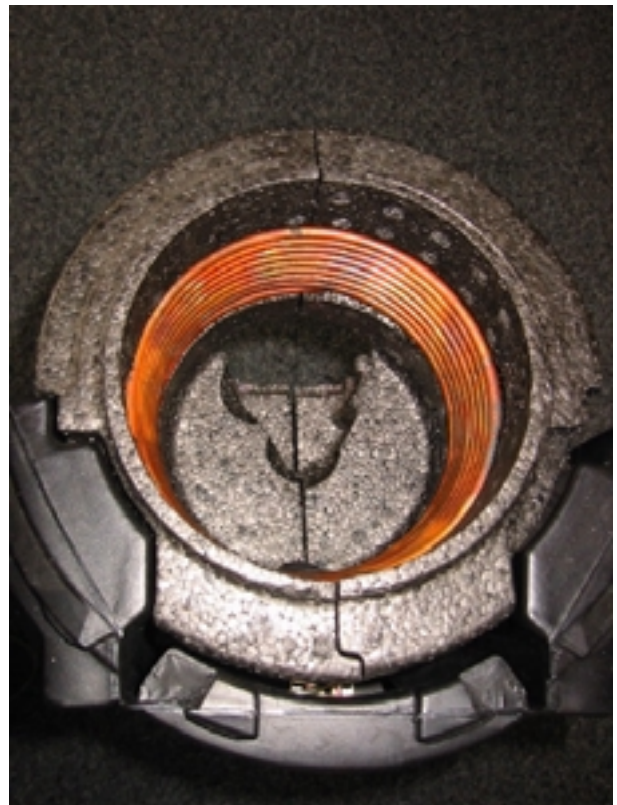
Fig. 2: Kühlschlange mit Isolation
