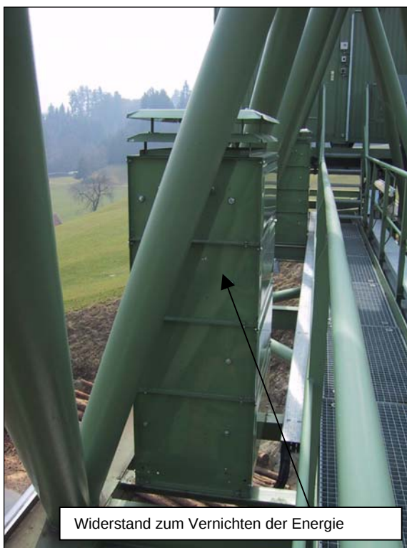
Abbildung 4.12: Widerstände des Portalkranes zur "Vernichtung" der Energie aus Absenken, Bremsen usw.
