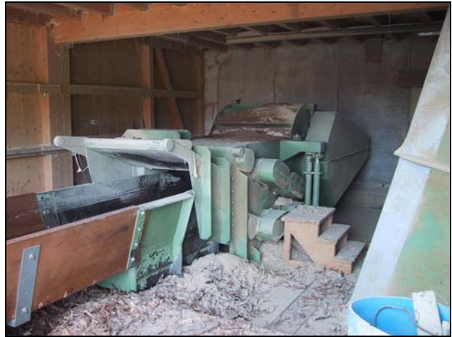
Abbildung 2.6: Über die Vibrarinne gelangt das Holz in den Einzug und danach in den Hacker. Der Hacker hat einen Antriebsmotor mit 200 kW.
