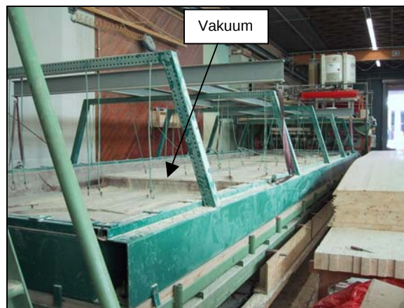
Abbildung 2.15: Leimwerk 3. An Stelle von hydraulischen Pressen wird hier mit Vakuum gearbeitet. Der Luftdruck drückt die zu leimenden Teile zusammen.
