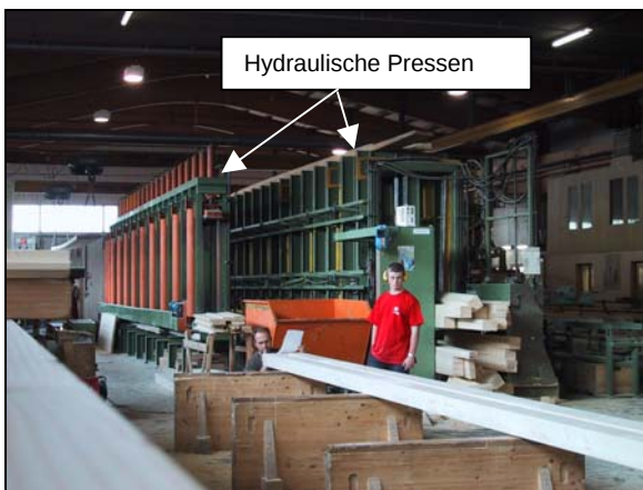
Abbildung 2.14: Leimwerk 1. In grossen hydraulischen Pressen werden die geleimten Einzelteile zu grossen Stücken zusammengefügt.
