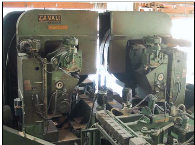
Abbildung 2.10: Bandsägen der Profilzerspananlage
