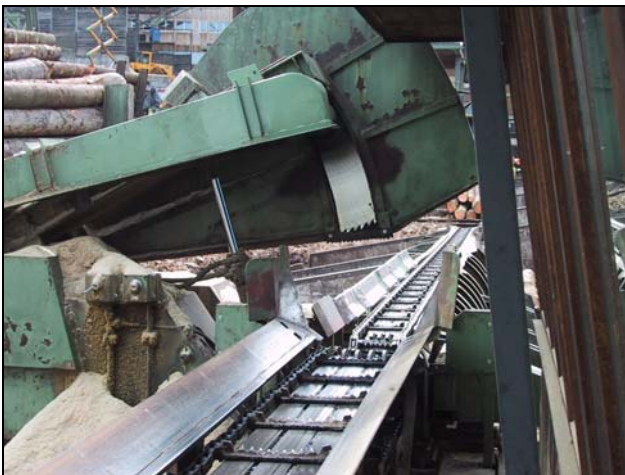
Abbildung 2.2: Rundholzplatz 1. Kreissäge bei Anlieferung. Hauptantrieb Kreissäge 37 kW.
