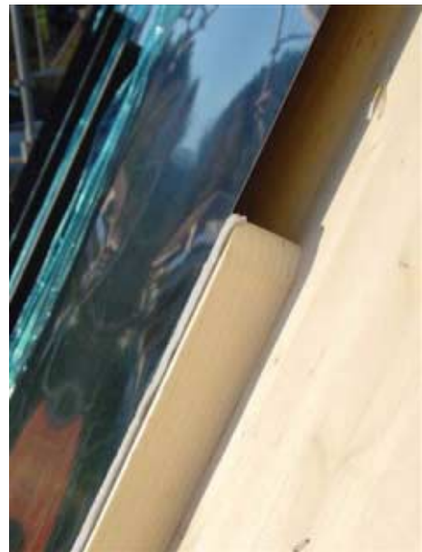
Abbildung 1: Montage des selektiven Absorbers. Das Glashalteprofil und das Solarglas wird danach auf die schwarz eingefärbte Unterkonstruktion montiert. Die Lufteintrittsöffnung (noch nicht schwarz eingefärbt) ist links unten sichtbar.
