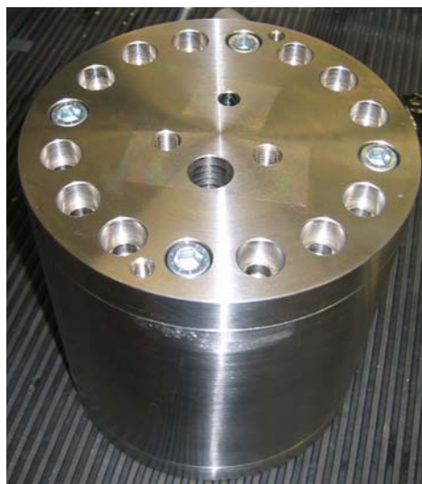
Figur 13: Probevolumen zur Funktionsüberprüfung der Entnahmesonde mit Anschlüssen für das FSV, ein Drucksensor, Gasspeisung und Entlüftung.
