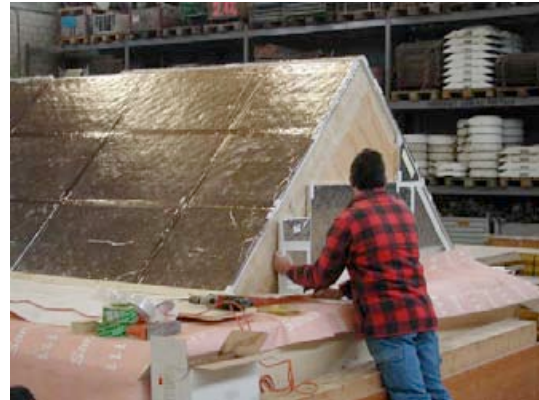
Fig. 26: Zusammensetzspiel mit durchnummerierten VIP-Platten im Werk
