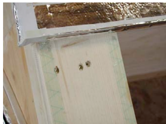
Fig. 25: Montage der VIP-Platten auf mit Klebeband vorbereitete Flächen im Werk
