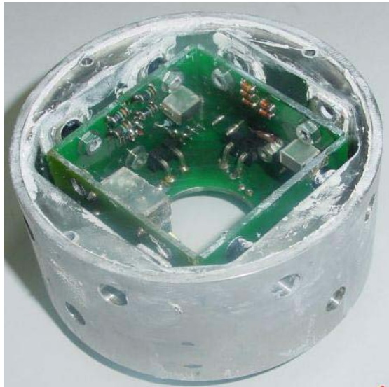
Bild 4: Rotorelektronik, links Elektronikgehäuse, rechts Kühlstern mit eingebauter und vergossener Elektronikeinheit
