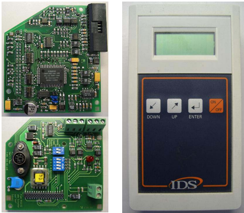
Bild 10: Steuerelektronik, links Baugruppen für Basic und Intelligent Version, rechts Hand-Held Bediengerät
