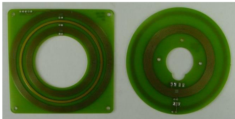
Bild 6: Signaltransformator, links: feststehender Teil, rechts: rotierender Teil
