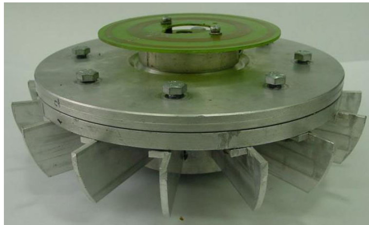
Bild 2: Demontierter Kühlstern mit rotierendem Teil des Signaltrafos
