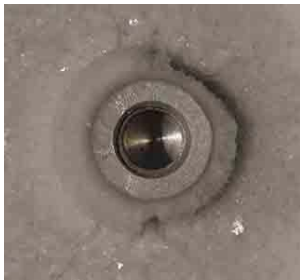
Abb.8-4: Frostbildung am Rohr in der ersten Rohrreihe nach 8 Stunden (Strömung von links nach rechts) V_{13} : w=1 m/s, \vartheta_L=9^\circ\text{C} , \varphi=60\% , \Delta T=13 K
