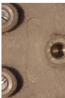
Abb. 8-10: Frostbildung hinter den Rohren der zweiten Rohrreihe nach 2 Stunden
