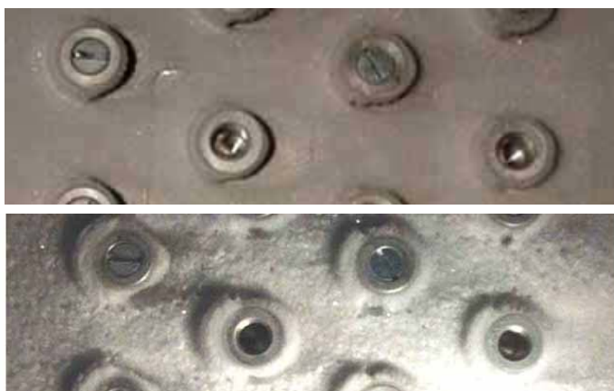
Abb. 8-6: Frost am Rohr in allen vier Rohrreihen nach 2 (oberes Bild) und nach 8 Stunden. Strömung von links nach rechts.
