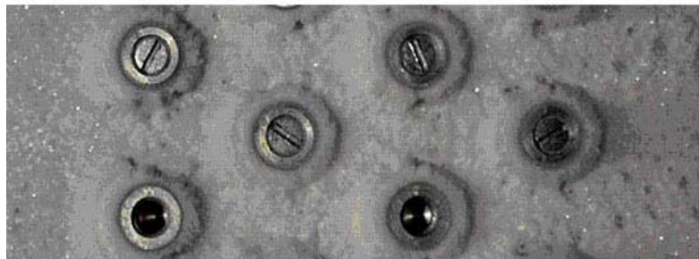
Abb. 8-13: Löcher im Frost nach 8 Stunden bei V04: w=2 m/s, \vartheta_L=4^\circ\text{C} , \varphi=85\% , \Delta T=8 K
