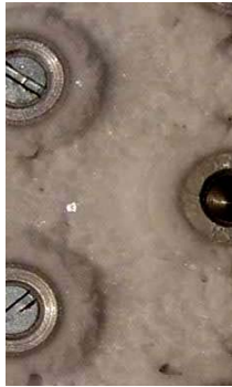
Abb. 8-11: Frostbildung hinter den Rohren der zweiten Rohrreihe nach acht Stunden Grundversuch V03: w=1 m/s, \vartheta_L=4^\circ\text{C} , \varphi=85\% , \Delta T=8 K
