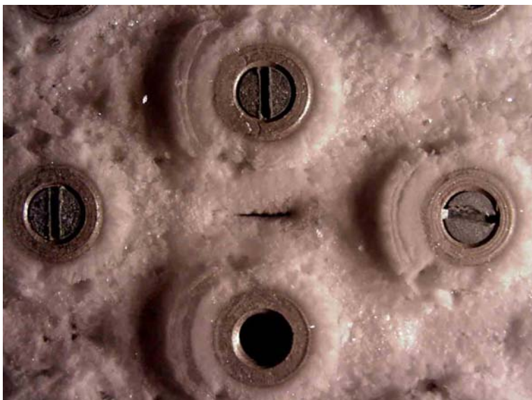
Abb. 8-17: Versuch V04m nach 8 Stunden: w=2 \text{ m/s} , \vartheta_L=4^\circ\text{C} , \varphi=85\% , \Delta T=8 \text{ K}
