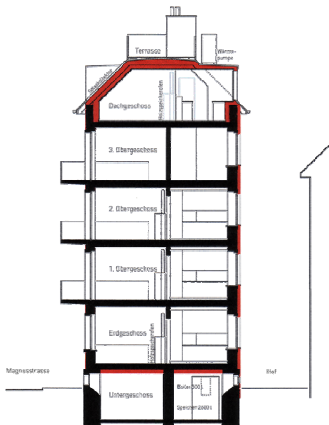
Abbildung 3-2 : Querschnitt durch den Passivhausumbau Magnusstrasse, rot die neu erstellten Gebäudeteile [15].
