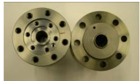
Figure 9: Le système pour monter la frette sur le rotor en utilisant la méthode hydraulique pour pré-contraindre la frette avant de la faire glisser sur le rotor avec un vérin hydraulique
