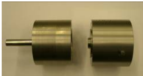
Figure 9: Le système pour monter la frette sur le rotor en utilisant la méthode hydraulique pour pré-contraindre la frette avant de la faire glisser sur le rotor avec un vérin hydraulique
