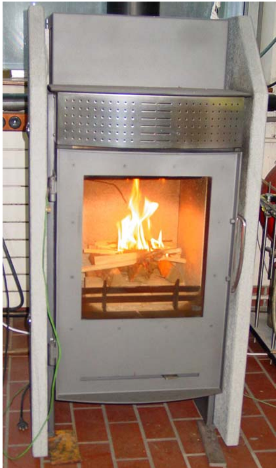
Bild 7: Ofentyp 2 im Idealbetrieb. Der Ofen wurde mit einer kleinen Menge trockenem Holz beladen und von oben angezündet (links). Nach Erreichen einer Grundglut wurden 2 kleine Holzstücke à 750 g nachgelegt (rechts).
