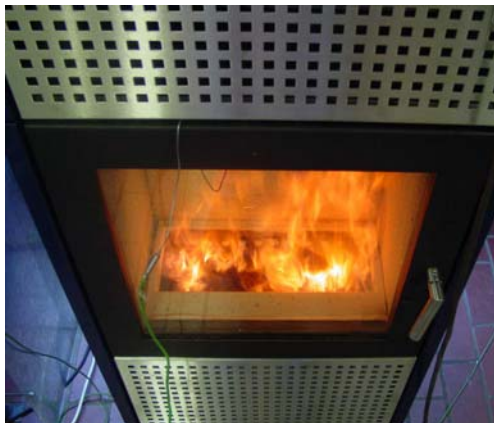
Bild 11: Flammenbilder von Ofentyp 3 bei stabilen Verbrennungsbedingungen. Die sichtbaren Flammen beginnen bei den Sekundärlufteinläufen am hinteren unteren Rand der Brennkammer. Die glimmenden Holzstücke liegen unter den Sekundärluftdüsen und sind kaum erkennbar.
