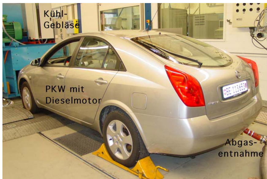
Bild 26 Personenwagen (Nissan Primera, Jg. 2003) mit Dieselmotor auf dem Rollenprüfstand. Um eine Überhitzung des Motors zu verhindern, wird das Fahrzeug mit einem Gebläse gekühlt. Das Abgas des Fahrzeugs wird direkt vom Auspuff abgeführt.
