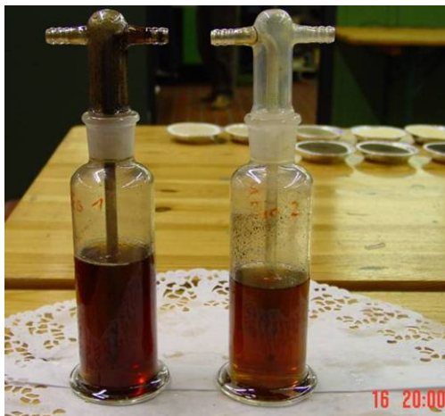
Bild 29 Proben von Holzofentyp 1 bei schlechtem Betrieb: Inhalt der Kondensatwaschflaschen (links) und Filter (rechts)
