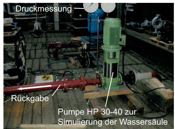
Versuchsanordnung im Prüflabor der Biral, Münsingen
