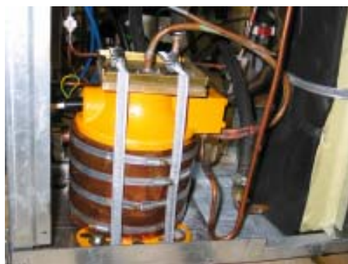
Abb. 19 Verdichter TN 1416 von Danfoss mit Kühlmantel auf der Oberseite und Kühlschnecke am Mantel. Für die Tests wurde der Verdichter isoliert.
