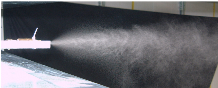
Abb. 21: Sprühbild der Mee Düse (ohne Zuluftstrom)
