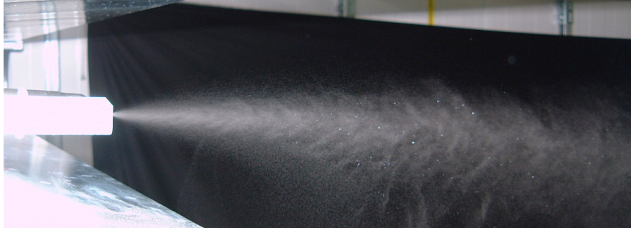
Abb. 20: Sprühbild der Stielow Düse (ohne Zuluftstrom)
