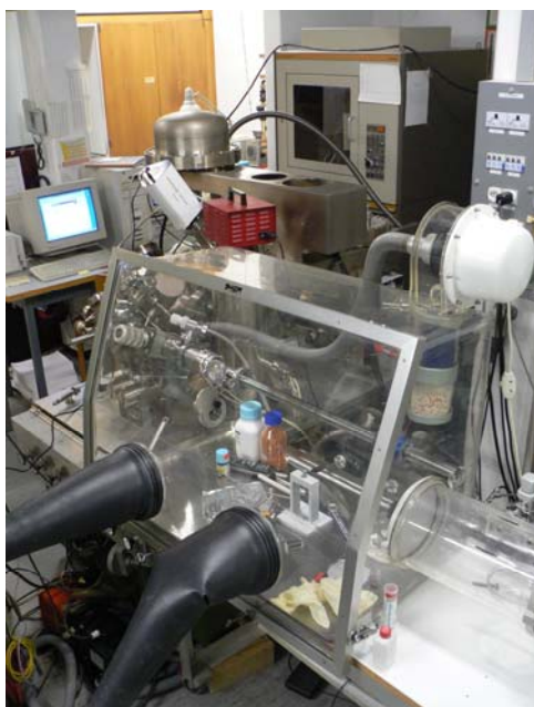
Fig. 3 : Argonkammer mit magnetischem Transfersystem in das Oberflächenanalysesystem zur Präparation von reaktiven Proben unter Abwesenheit von Wasser und Sauerstoff.
