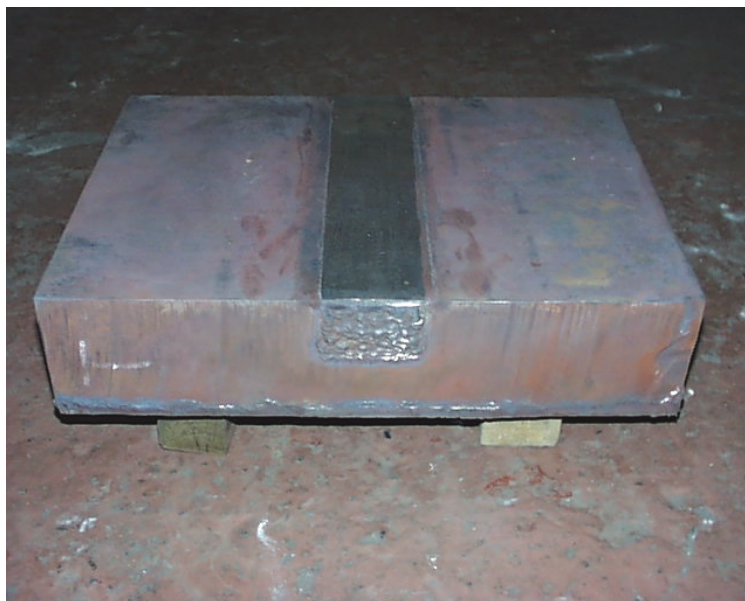
Figur 3: Simulierte Inconel-182/SA 508 Cl. 3-Mischnaht zum Studium des Korrosionsrisswachstumsverhalten im Übergangsbereich zwischen Inconel-182-Schweisgut und unbeeinflusstem RDB-Grundwerkstoff.
