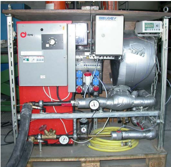
Figure 5 : Vue du module de chauffage utilisé pour le test de réponse dans sa nouvelle configuration (télétransmission des données, coffret central et capteurs de pression, en bas à gauche)
