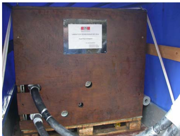
Figure 9: Module de chauffage fermé, protégé par la bâche de la remorque, lors des tests de réponse thermique.
