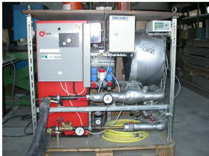
Figure 5 : Vue du module de chauffage du LMS-EPFL avec le système de télétransmission RMS-Lite
