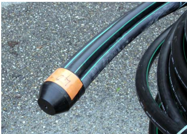
Figure 2: Détail de la tête de la sonde géothermique
