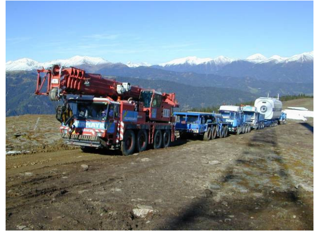
Abb. 5: Transport einer Maschinengondel bei 18% Steigung in Oberzeiring (A)
