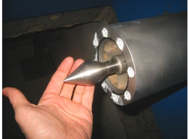
Düsenadel vor dem Aufsetzen des Mundstückes. Hier schießt das Wasser künftig mit fast 500 km/h heraus. Bild: Gian-Andri Tannò, ITE-CO
