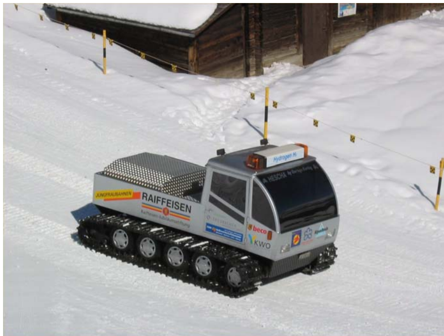
Abb. 15. Talfahrt des Wasserstoff angetriebenen Pistenfahrzeugs.
