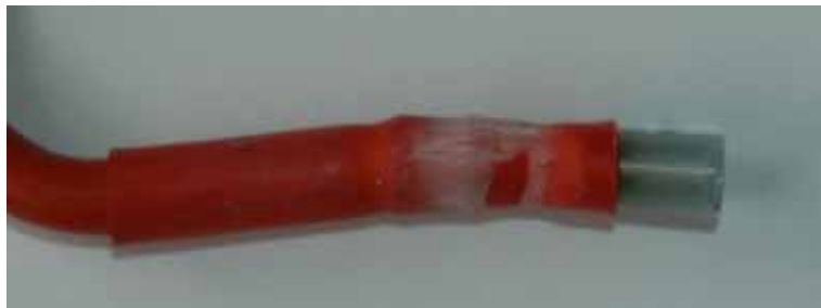
Abbildung 4-22: Flachstecker mit Schrumpfschlauch
