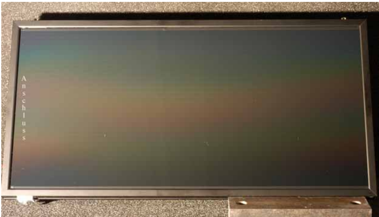
Abbildung 7-8: Regenbogenfarbige Verfärbung des Moduls
