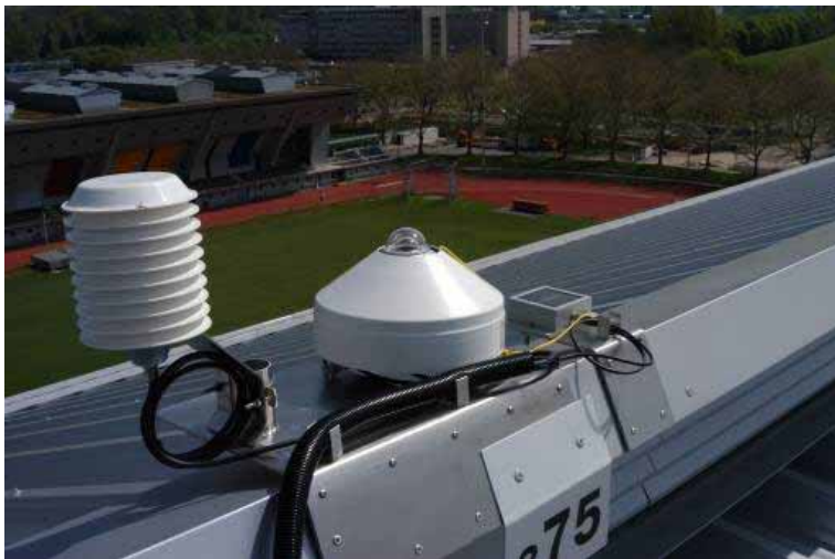
Abbildung 3-69: Sensoren verschatten sich
