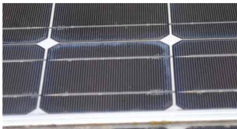
Abbildung 4-52: Verfärbung am Zellenrand
