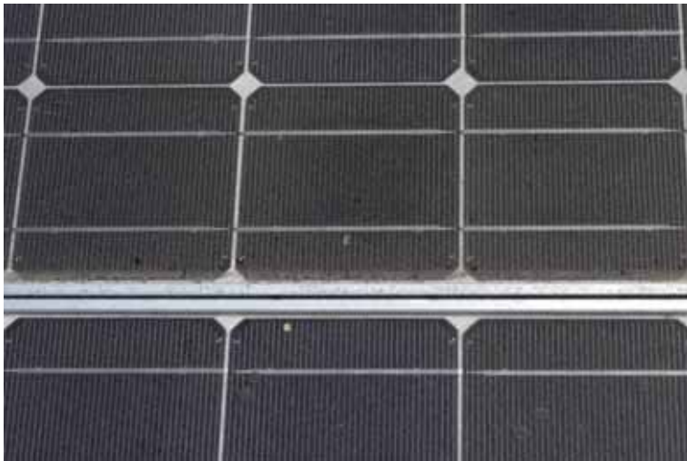
Abbildung 4-7: Verschmutzung im August 2005
