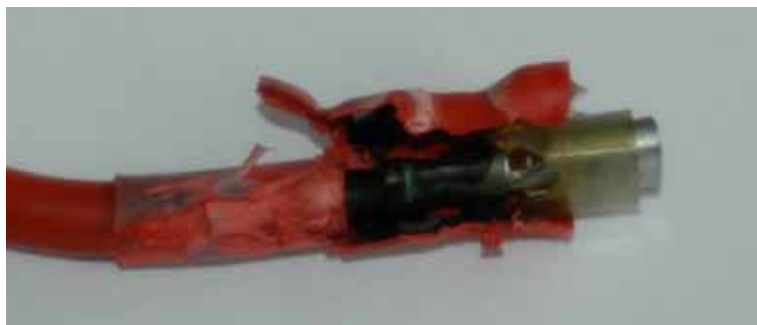
Abbildung 4-23: Flachstecker mit aufgeschnit-tenem Schrumpfschlauch
