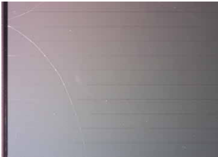
Abbildung 7-11 CIS-Modul WS11003 mit Riss im rückseitigen Substrat
