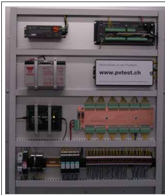
Abbildung 3-67: Tableau mit der Messdatenerfassung
