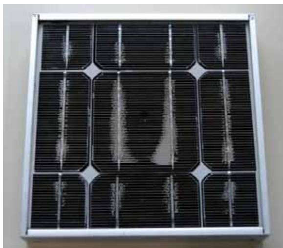
Abbildung 3-4: delaminierte Arco Referenzzelle
