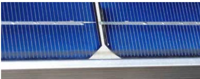
Abbildung 4-12: Rückstände trotz Reinigung
