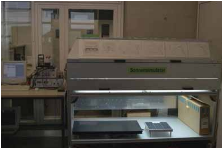
Abbildung 7-1: Sonnensimulator mit Messinterface (links)
