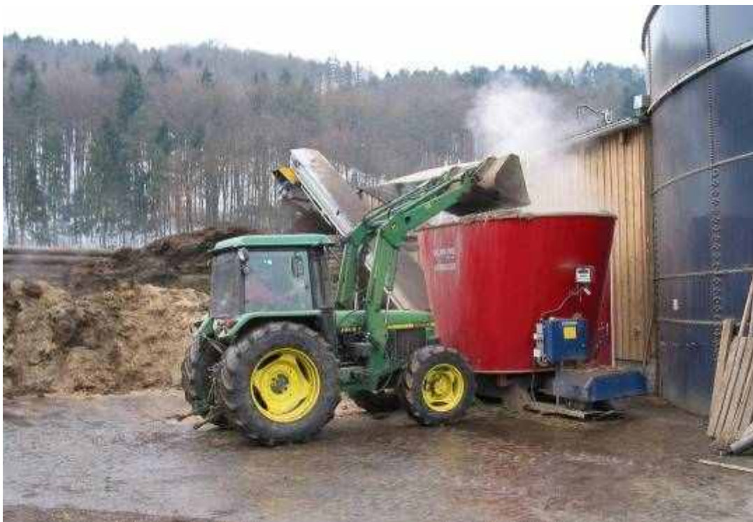
Fig. 12: Eine Förderschnecke bringt die Substrate direkt in den Fermenter.
