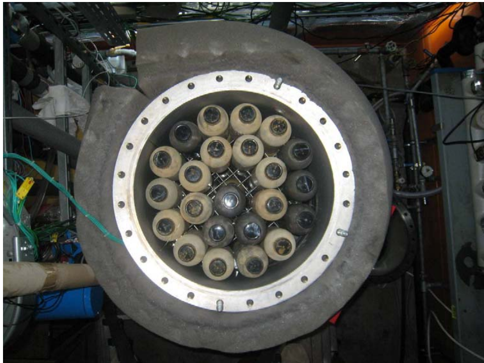
FIGURE 7: DISPOSITION DES PCM DANS LA CUVE (SAG)
