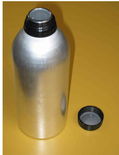
Figure 70 Arpège (à gauche), le récipient en aluminium utilisé pour contenir le PCM (à droite).
