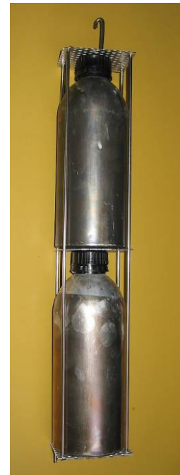
Figure 56 : Système d'accrochage des bouteilles.
