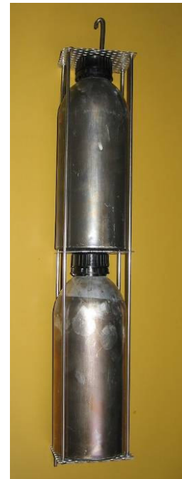
Figure 17 : Système d'accrochage des bouteilles.
