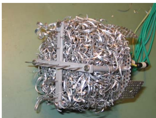
(a) disposition des thermocouples.
