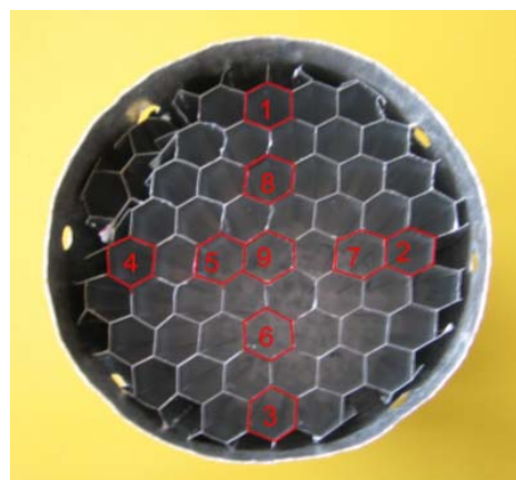
Figure 23 : Disposition des thermocouples dans le nid d'abeilles.
