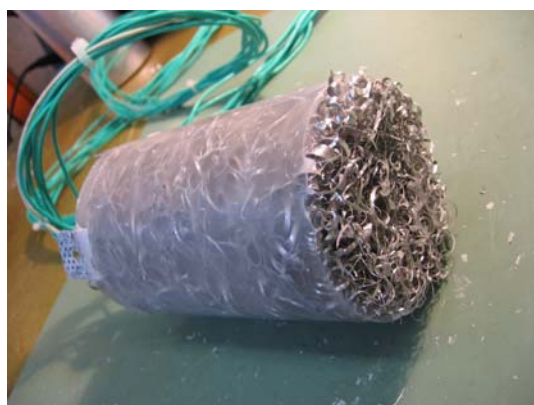
(b) bloc de paraffine avec copeaux d'aluminium.
