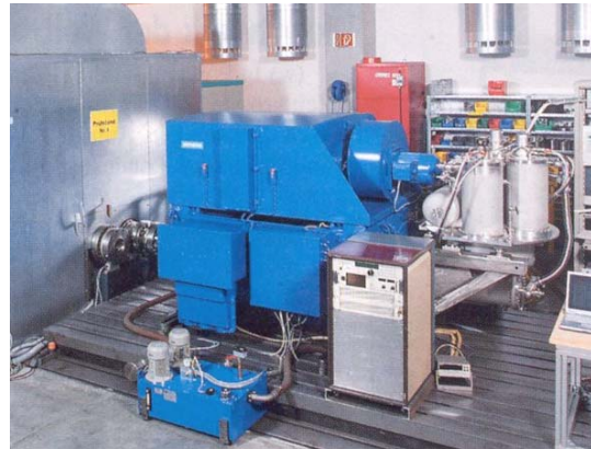
Fig. 3: 4MVA-Generator im Test (Siemens)
