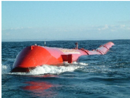
Fig. 10.7 Foto eines Pelamis-Prototyps in Originalgrösse. b
