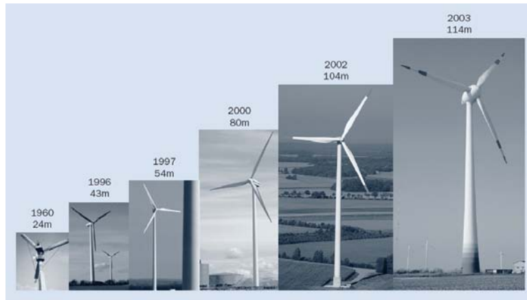
Fig. 5.2 Entwicklung der Grösse von typischen Windkraftanlagen zwischen 1980 und 2003 (Quelle: EWEA 2004a).
