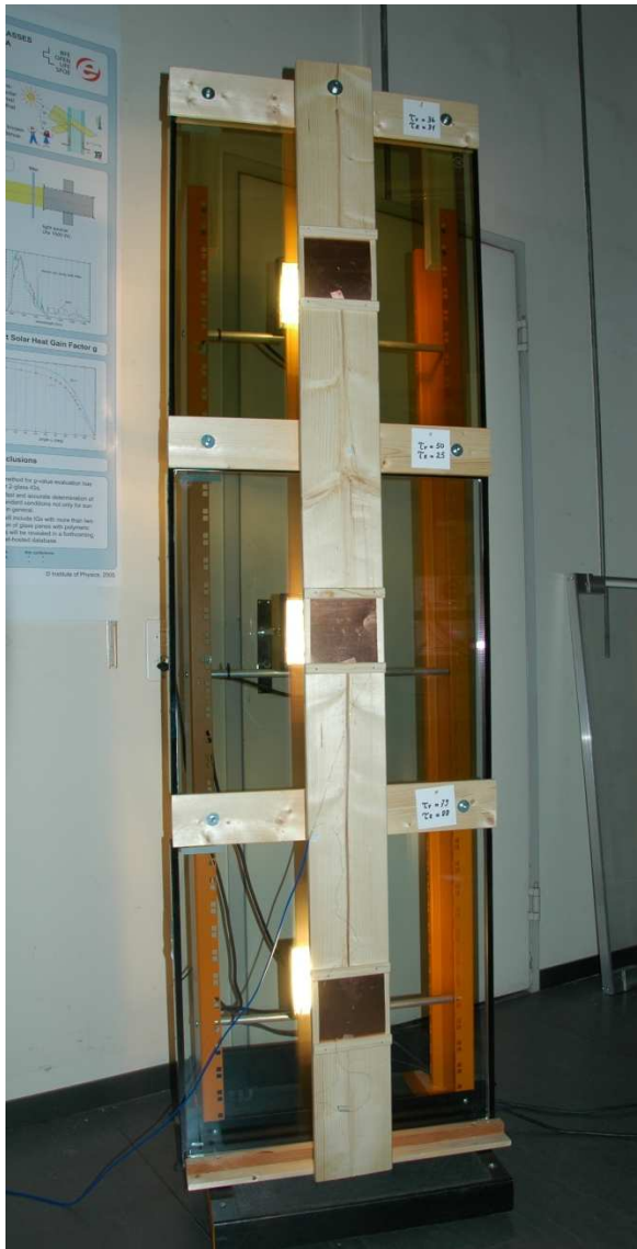
Fig. 3.1: Sonnenschutz-Demostand mit drei Halogenstrahlern und vorgesetzten Absorberblechen.
