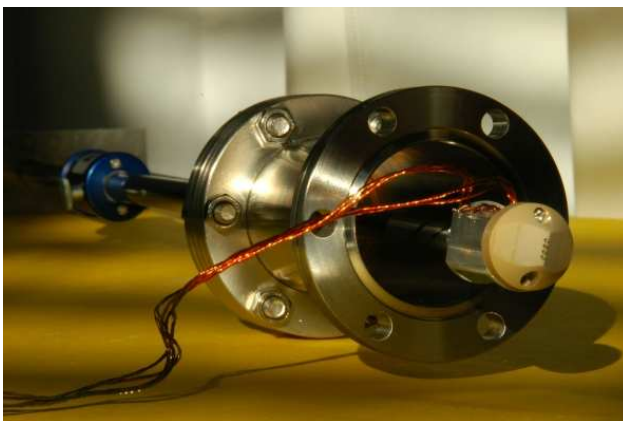
Fig. 1.1: Messkopf für die in-situ Messung des spezifischen Widerstandes von dünnen Filmen, die im Vakuum hergestellt wurden.
